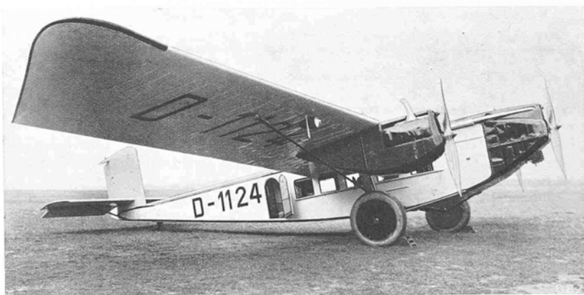
Abb. 17. Rohrbach-Roland, 3 \times 320 PS; SpW 26 m, L 16,4 m, G = 4130 + 3070 kg, 170 km/h, 10 Passagiere. Deutsche Lufthansa. Zürich-München-Wien.
